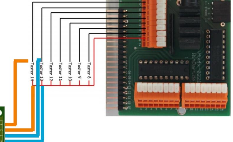
Man kann diese auch einfach parallel am Taster anschließen.
